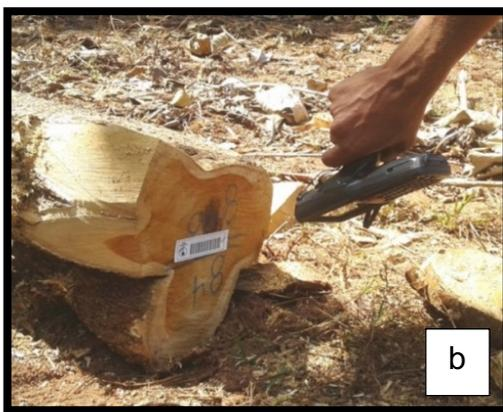
**Figura 1.** (a) Operações de etiquetagem e (b) registro do código de barras nas toras de teca.
