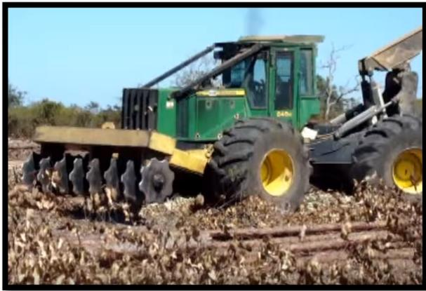
**Figura 2.** Skidder John Deere 848H com desgalhador acoplado. Fonte: <https://www.youtube.com/watch?v=AOS S4x4UHtc&t=3s>
