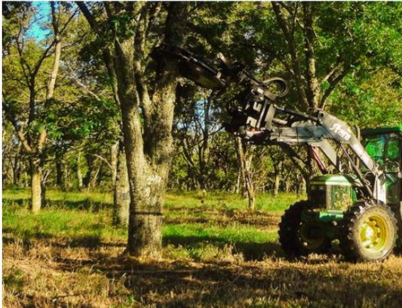
**Figura 2.** Colheita mecanizada de noqueira-pecã com o *shaker*. Fonte: Eric Porto Gindri.
